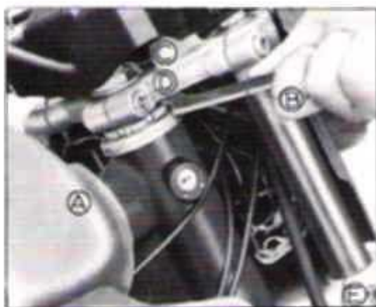
FIG. 128 - AJUSTE DA FOLGA DO GUIDOM
