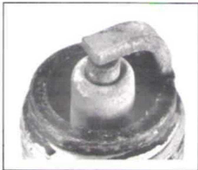
FIG. 18A - CONDIÇÃO NORMAL DE USO
