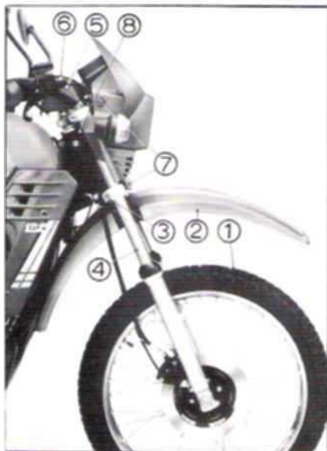
FIG. C19 - DESMONTAGEM DOS SUPORTES
