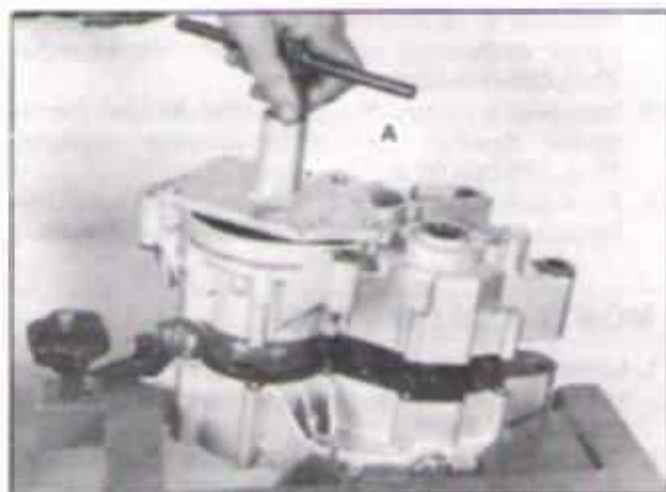
FIG. M25 - A. FERRAMENTA ESPECIAL PARA ABERTURA DOS SEMI-CÁRTER
