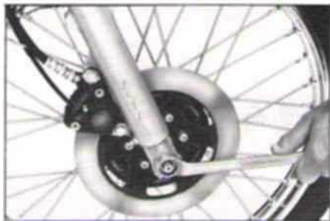
FIG. C2 - DESMONTAGEM DA RODA DIANTEIRA
