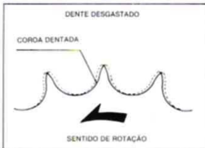
FIG. C17 - DESGASTE DOS DENTES.
