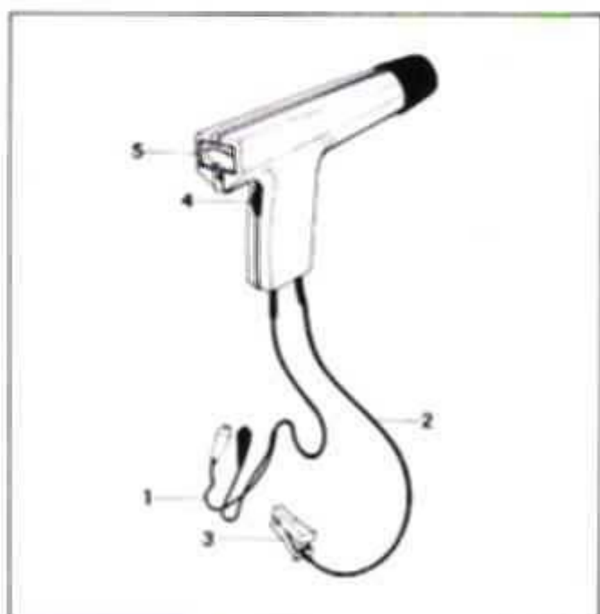
FIG. I25 - PISTOLA ESTROBOSCÓPICA 1. Cabo de conexão à bateria 2. Cabo do emissor 3. Emissor 4. Rodízina de ajuste 5. Instrumento de medição
