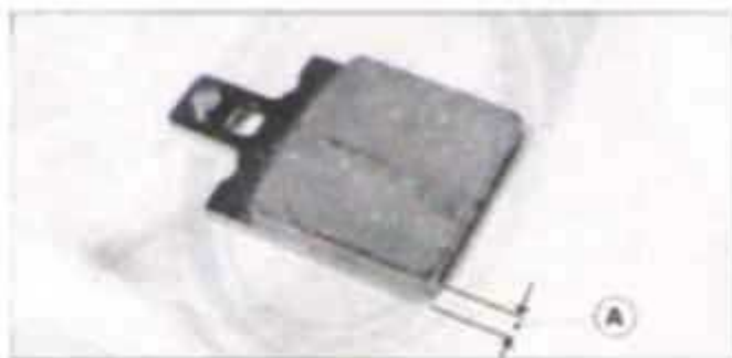
FIG. C5 - PASTILHAS DO FREIO DIANTEIRO A. Faixa de uso
