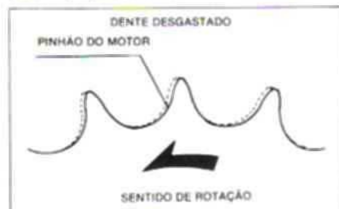
FIG. 115 DESGASTE DOS DENTES
