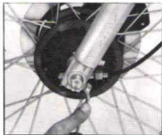
FIG. C3 - DESMONTAGEM DA RODA DIANTEIRA
