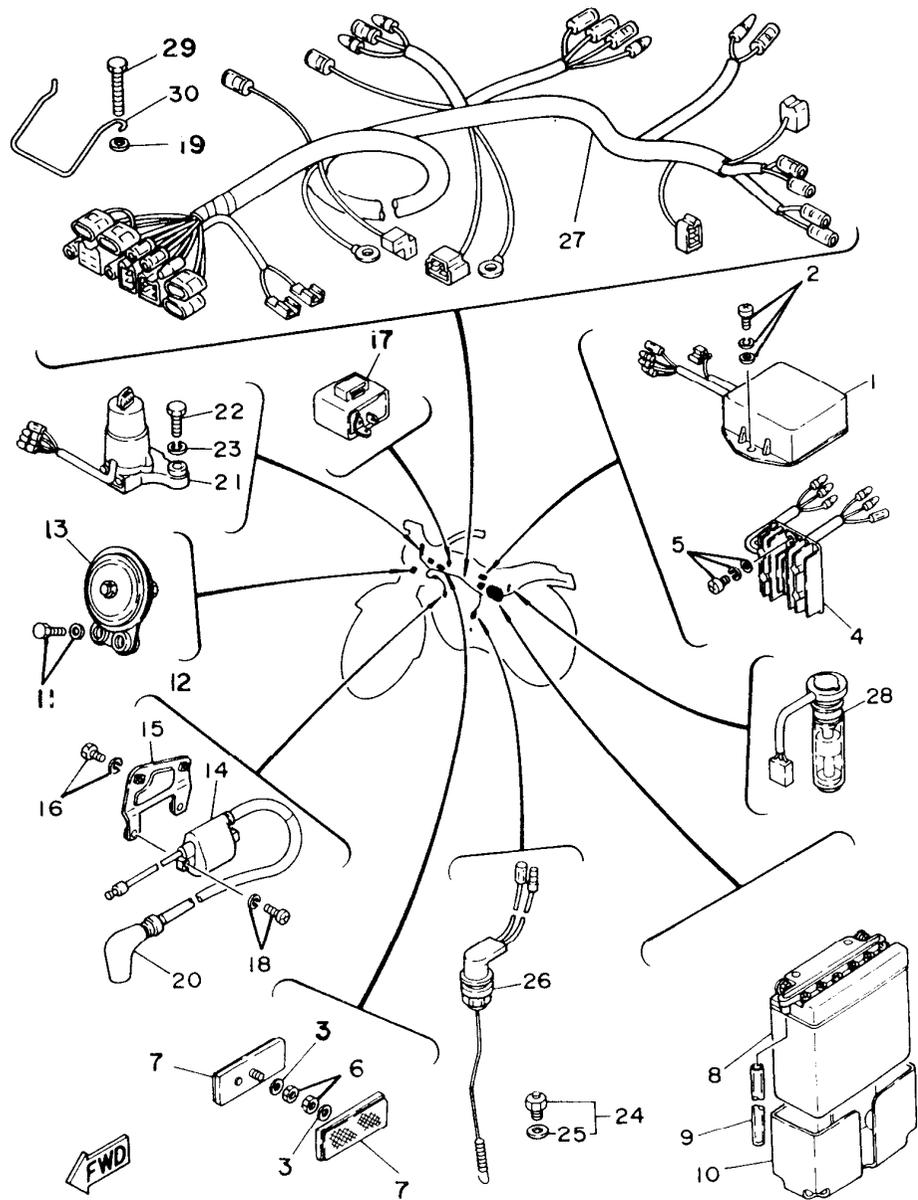
FIG. 33 – SISTEMA ELÉTRICO
