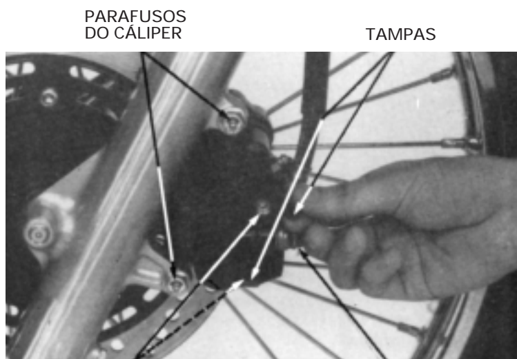
PINOS DAS PASTILHAS PARAFUSO DA MANGUEIRA DO FREIO
