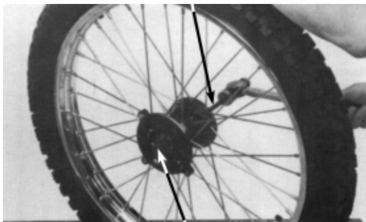
CABEÇOTE DO EXTRATOR DE ROLAMENTO, 15 mm (07746-0050400)
